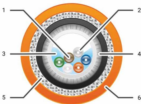
1. Coeur : OM3 / OM4 - Fibre de verre 50  $\mu\text{m}$  / 125  $\mu\text{m}$
